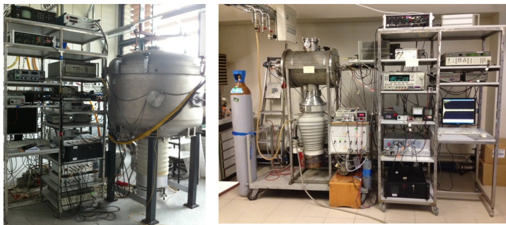
FIG. 4. Spectromètres MJ-FTMW utilisés dans ce travail, situés à Aachen (2-26.5 GHz) et à Créteil (26.5-40.0 GHz) 1-3 .
