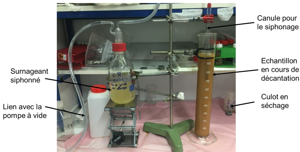
Figure 9 : Allonge de 1 L lors de la séparation de la fraction < 2 µm d'un échantillon de résidus de traitement de McClean avec surnageant récupéré lors d'une première étape de siphonage.
