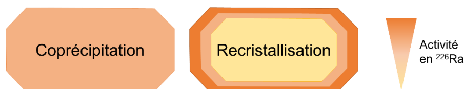
Figure 24 : Représentation de la répartition de l'activité du ^{226}\text{Ra} dans des minéraux de barytines A/ dans le cas d'une coprécipitation et B/ dans le cas d'une recristallisation.
