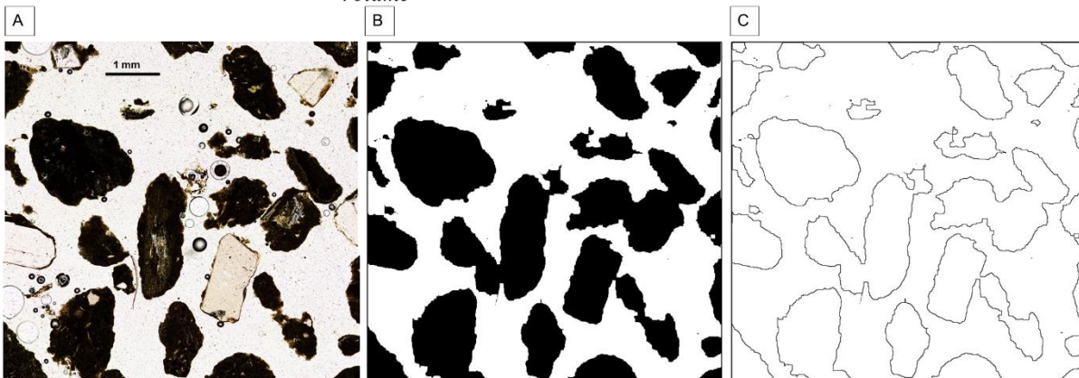
Figure 52 : A/ Image optique d'une zone de l'échantillon de zéolithes prélevé en profondeur et de l'échantillon prélevé en surface, B/ traitement de l'image de façon à faire ressortir le volume de minéral et C/ sa surface via le contour des ensembles.
