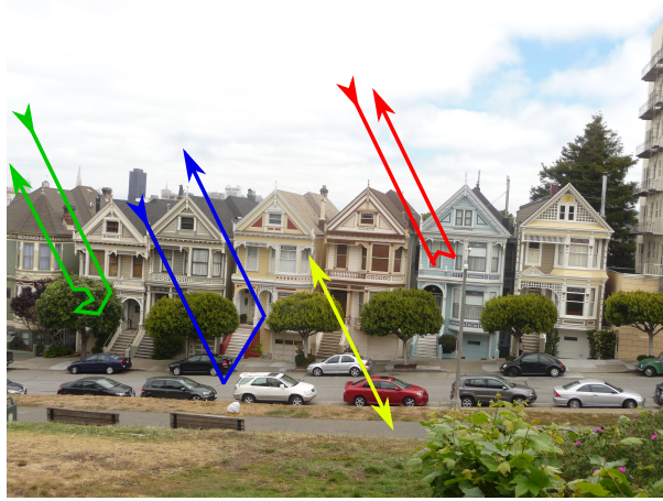
FIGURE 2.2 – Schéma représentant différents scénarios de rétrodiffusion : ● les surfaces, ● les doubles rebonds, ● les triples rebonds, ● les rebonds multiples. Photos des Painted Ladies ©Jacques Weissgerber.
