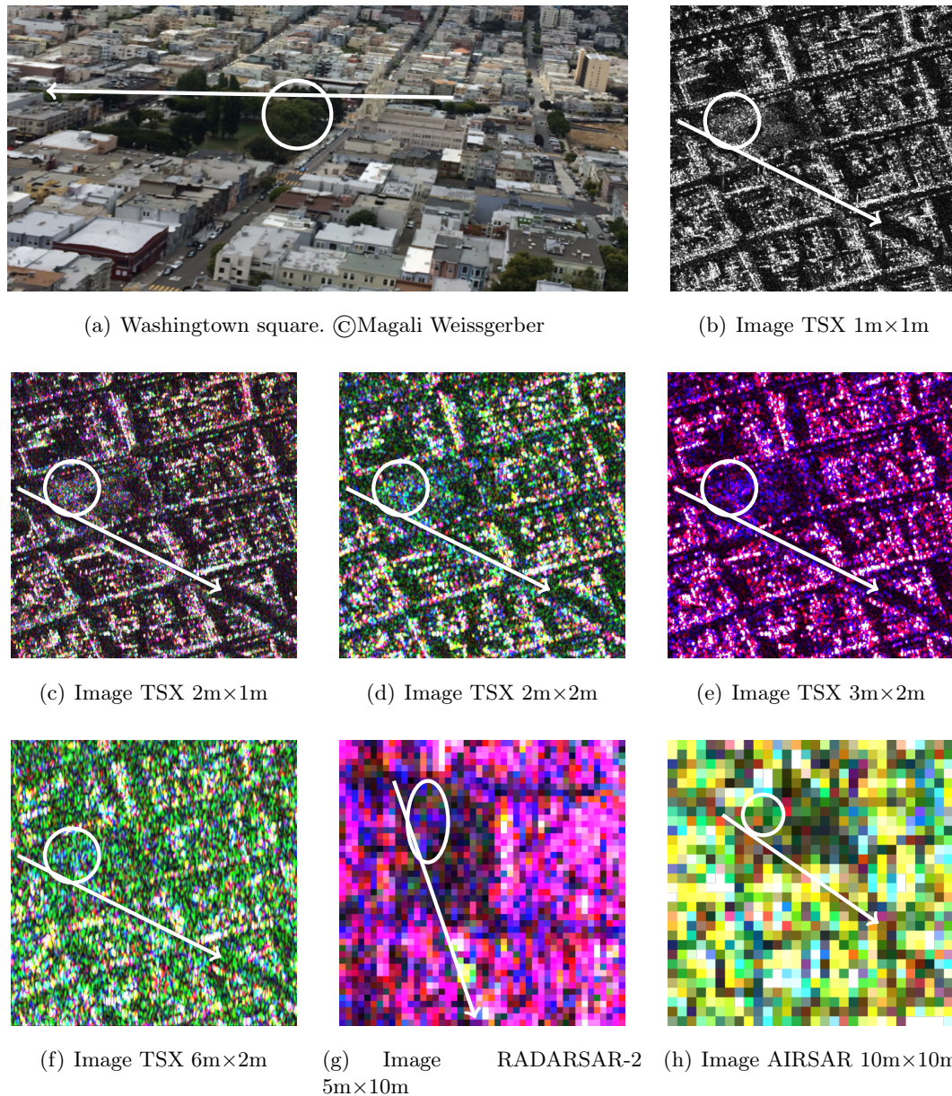
FIGURE 2.3 – Washington Square, San Francisco. Images SAR de résolutions différentes. → Columbus Avenue ◦ bosquet d'arbres. Les couleurs sont codées dans la base de Pauli : HH+VV , HH-VV , 2HV . Les seuils et les couleurs en polarimétrie seront discutés en annexe E.
