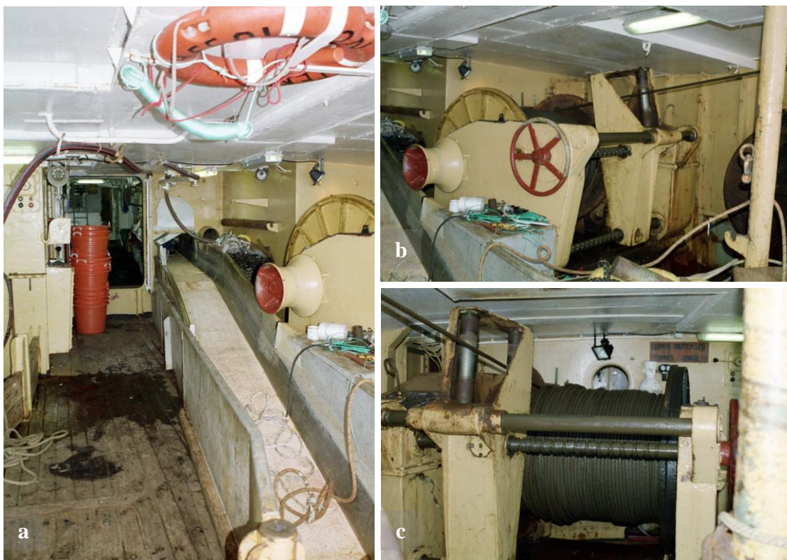
Le chalutier OPÉRA : Vue intérieure. a – tapis de tri s'étirant jusqu'à la cale froide (arrière plan) ; b – treuil hydraulique tribord ; c – fûnes enroulées sur le treuil bâbord.
