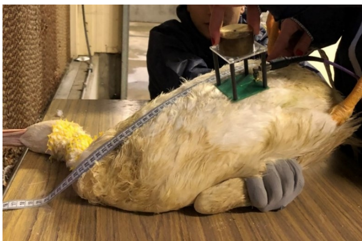
Figure 73 : Photographie de l'expérimentation RF in-vivo avec la version optimisée du capteur CapV0_4
