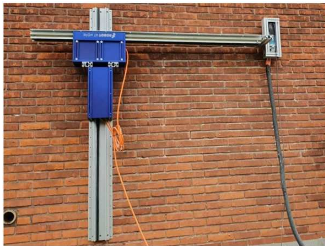
FIGURE 2.3 – Robot ratisseur de joints [6].
