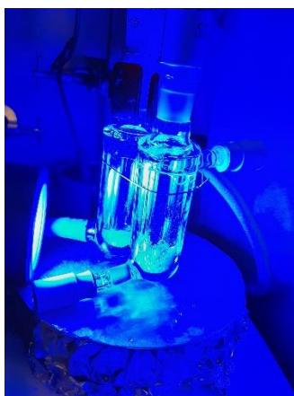
Photo 2 : Tubes à double parois utilisés
