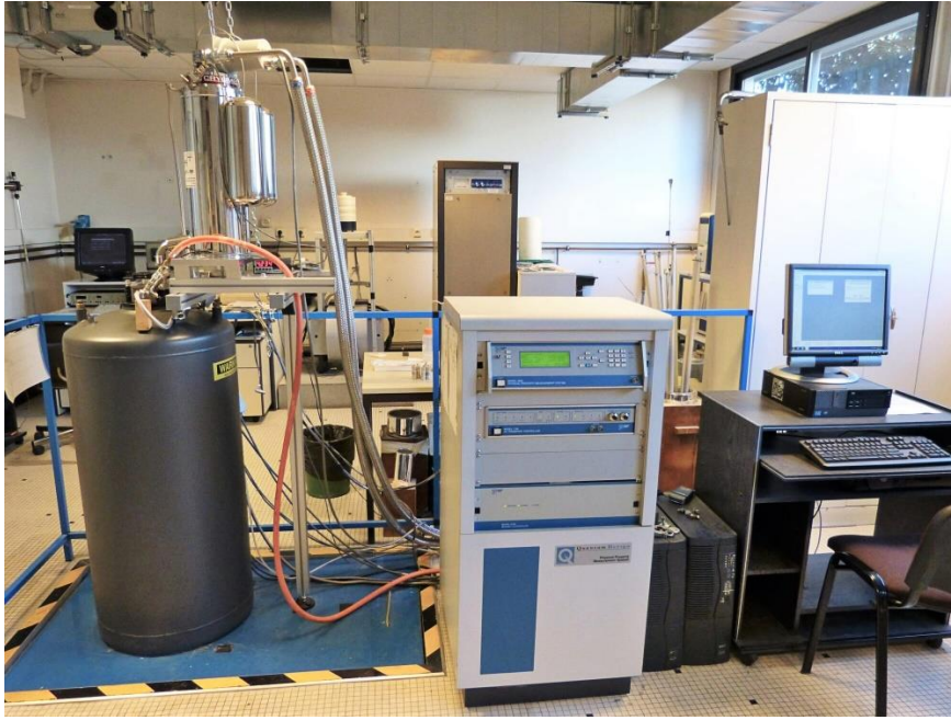
Figure 27: PPMS utilisé pour les mesures de résistivité électrique et de résistivité de Hall des échantillons dans la gamme 2,5 K à 300 K [22].
