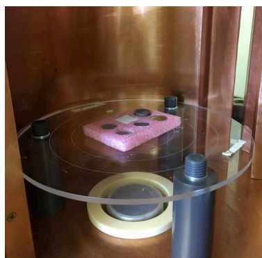
FIGURE 2.13 – Configuration de détection dans le dispositif à bas bruit de fond pour les pastilles en 2021.
