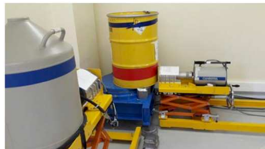
FIGURE 1.3 – Station de spectrométrie gamma pour des colis de déchets au CEA Cadarache [2].
