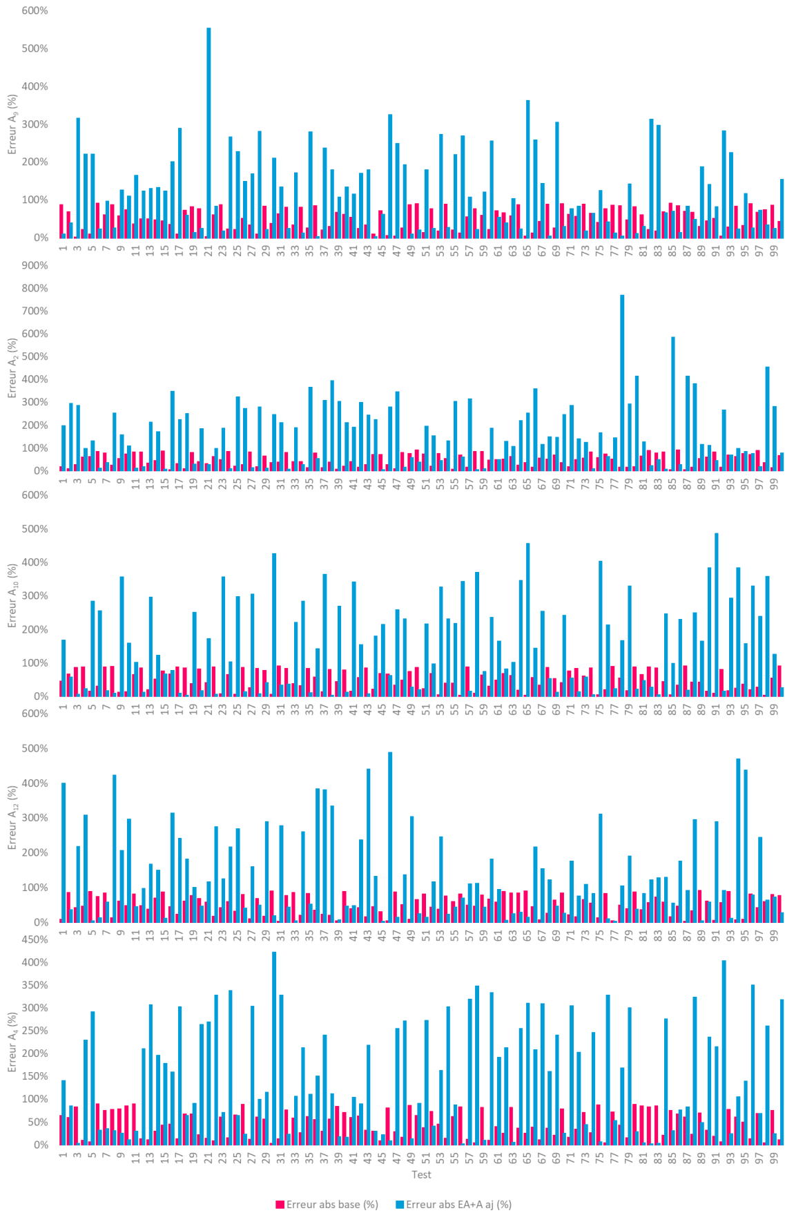
Figure 4.41 : Erreur entre l'A utilisé pour produire l'essai fictif et l'A ajusté (en bleu) en comparaison avec l'erreur entre A utilisé pour produire l'essai fictif et l'A base (en rose)
