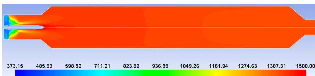
Figure 2.13 : Profil de température (K) de la configuration 1 du réacteur de 5m 3 avec un angle d'injection de 90°
