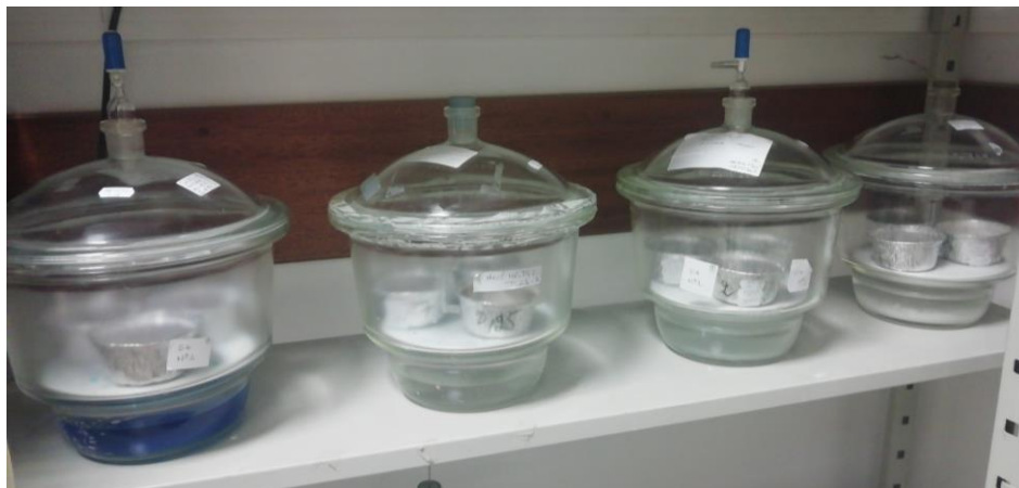
Figure IV.3. Conservation des échantillons dans les enceintes des solutions salines
