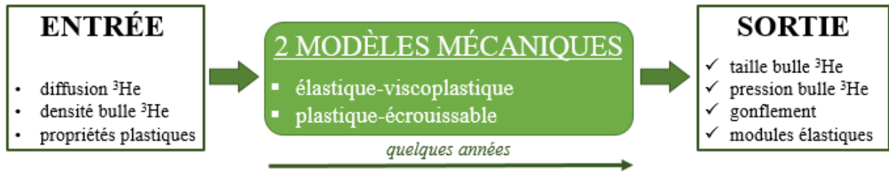
Figure 6-5 – Données d’entrée et de sortie des deux modèles mécaniques utilisés pour la modélisation de la phase de croissance du vieillissement.
