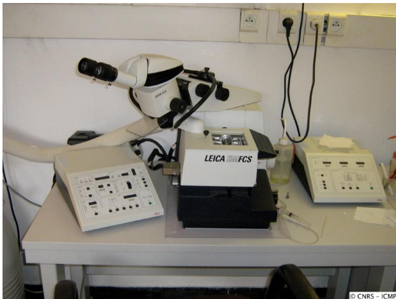
Figure 2-2 – Photo de l'ultramicrotome Leica utilisé pour la découpe de lames minces (ICMPE).
