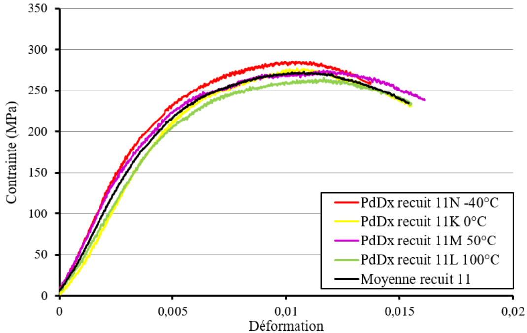
Figure 5-6 – Essais de traction réalisés sous 4,5 bar de pression de D_2 sur plusieurs fils de deutérure de palladium issus du recuit 11 (notés PdD x ) deutérés à -40°C, 0°C, 50°C et 100°C.
