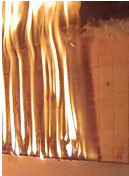
Figure 4-25 : Similarité entre les positions du front de pyrolyse et du front de flamme
