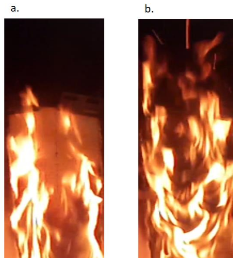
Figure 4-18 : Carbonisation de la surface de l'échantillon, a. 10 s après l'inflammation, b. 40 s après l'inflammation
