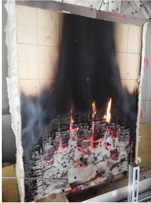
Figure 5-7 : Echantillon en fin de test, après environ 20 minutes d'exposition. Le panneau radiant est éteint à cet instant.
