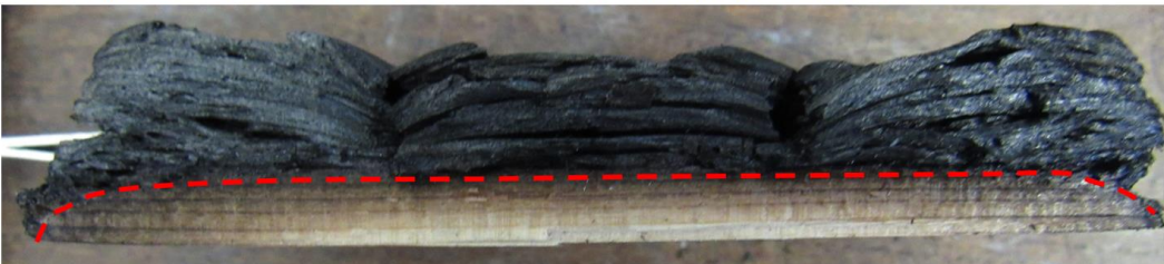
Figure 3-14 : Front de pyrolyse pour un flux de 30 \text{ kW.m}^{-2} , a. Après une exposition de 200 secondes, b. Après une exposition de 800 secondes
