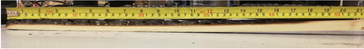
Figure 4-6 : Coupe dans le sens de la longueur et à mi-hauteur de l'échantillon, représentant l'évolution de l'épaisseur de char après une exposition de 400 secondes.
