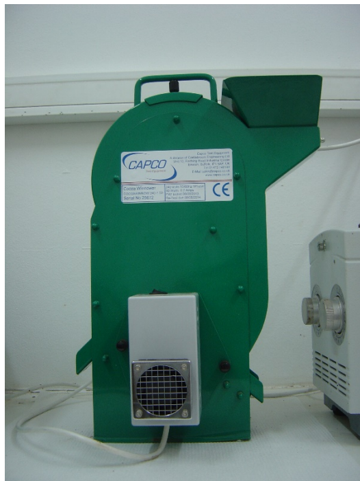
Figure 3. Catador pour séparation des coques et du grué (marque Capco)
