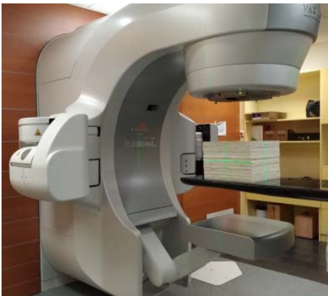
Figure IV-1 : Système permettant la mesure de la distribution de dose 2D dans le plan d'isocentre d'un fantôme de 25cm d'épaisseur. Les lignes vertes représentent les lasers permettant le positionnement des patients sur la table. Leur point de croisement représente le point d'isocentre de la machine. L'EPID est situé derrière le fantôme avec son bras rétractable.
