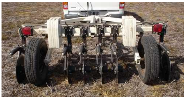
Figure 3. Exemples de systèmes tractés utilisés pour la mesure de résistivité à grande échelle spatiale : dispositifs Veris 3100 (à gauche) et MUCEP (à droite)
