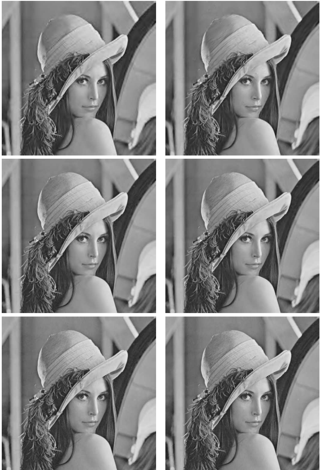
FIG. 4.17: Codage de l'image lena par EBCOT après décomposition en ondelettes séparables [gauche] et orientée [droite]. Les débits et les PSNR pour la transformée en ondelettes séparables et orientées sont respectivement de [haut] 33.33 dB et 33.64 dB à 0.2 bpp, [milieu] 37.55 dB et 37.58 dB à 0.5 bpp, et [bas] 40.51 dB et 40.42 dB à 1.0 bpp.
