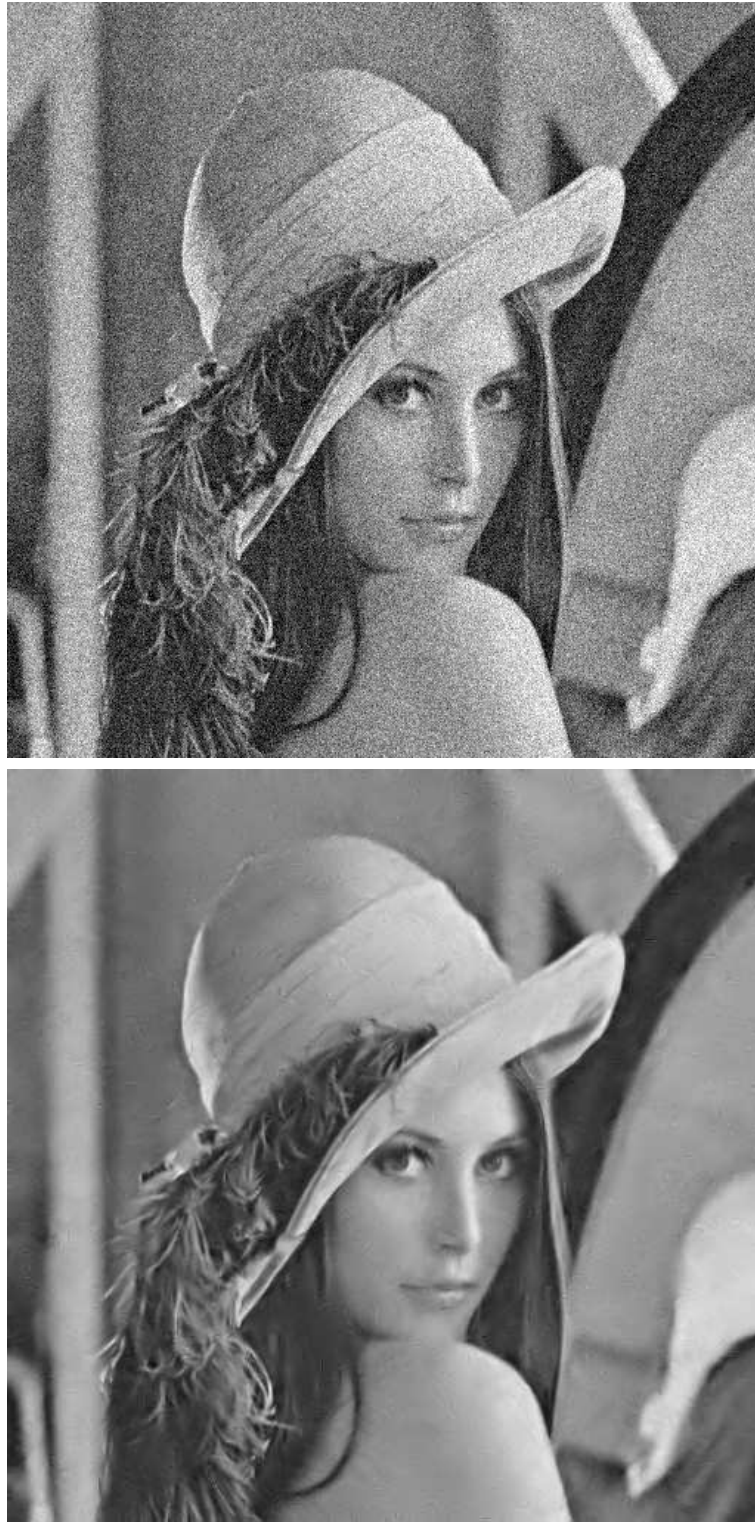
FIG. 4.25: Expérience de débruitage. [haut] L'image lena bruitée par un bruit blanc additif gaussien d'écart type \sigma_N = 25 (PSNR = 20.2dB). [bas] L'image reconstruite après débruitage par ondelettes orientées (PSNR = 30.6dB).
