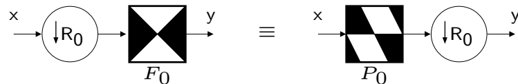
FIG. 3.5: Transformation des filtres en éventail en filtres en parallélogramme. La paire de filtres en éventail (F_0, F_1) devient une paire de filtres en parallélogramme (P_0, P_1) après inversion du filtrage et du sous-échantillonnage par R_0 .
