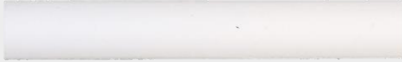
Figure 73 Tronçon d'extrudat sec obtenu à une vitesse de sortie de 9 mm.s -1 correspondant à une poussée à 1 mm.s -1 , 10 mm de diamètre et 80 mm de longueur
