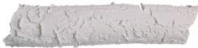
Figure 56 Délaminations en sortie d'extrudeuse sur la formulation contenant 7% m,c de liant Optapix S51, 2,5% m,c de plastifiant Zusoplast C92 et 5% m,c de lubrifiant Zusoplast 126/3
