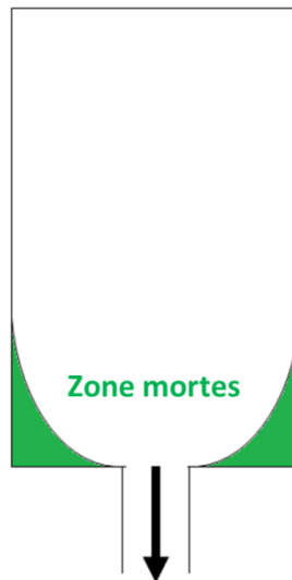
Figure 10 Schématisation des zones mortes en extrusion (en vert)
