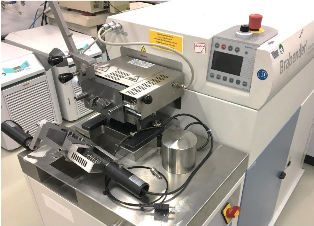
Figure 30 Chambre de malaxage 30cm 3 de l'équipement Brabender
