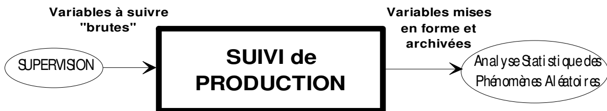
Figure 66 : Bloc fonctionnel du suivi de production
