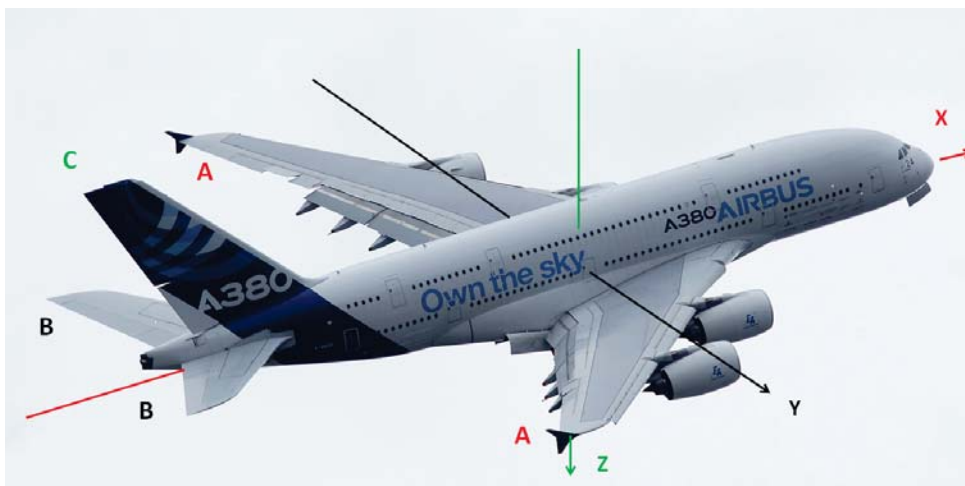
FIGURE 1.2 – Gouvernes d'un avion.
