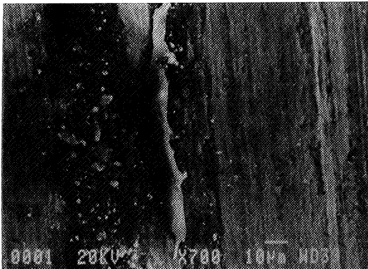
Figure 20 : Copeau de polyéthylène transféré à la surface d'un disque de TA6V.
