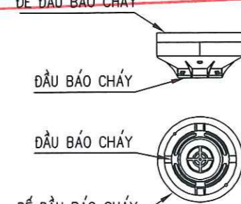
CHI TIẾT ĐẦU BÁO CHÁY
