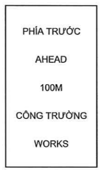
01) Biển báo 441b Báo hiệu phía trước có công trình thi công
