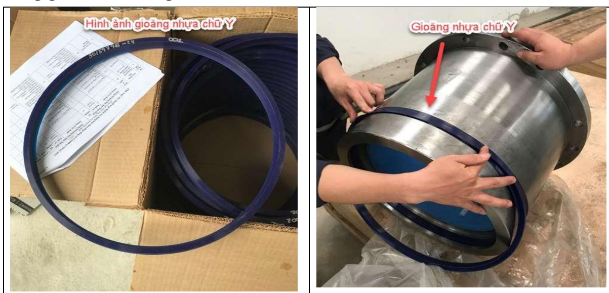
Hình: Gioăng nhựa chữ Y đã thay thế cho các Tổ máy H1, H4, H6 NMTĐ Sơn La và sẽ thay thế cho H2 NMTĐ Sơn La cuối năm 2025.
