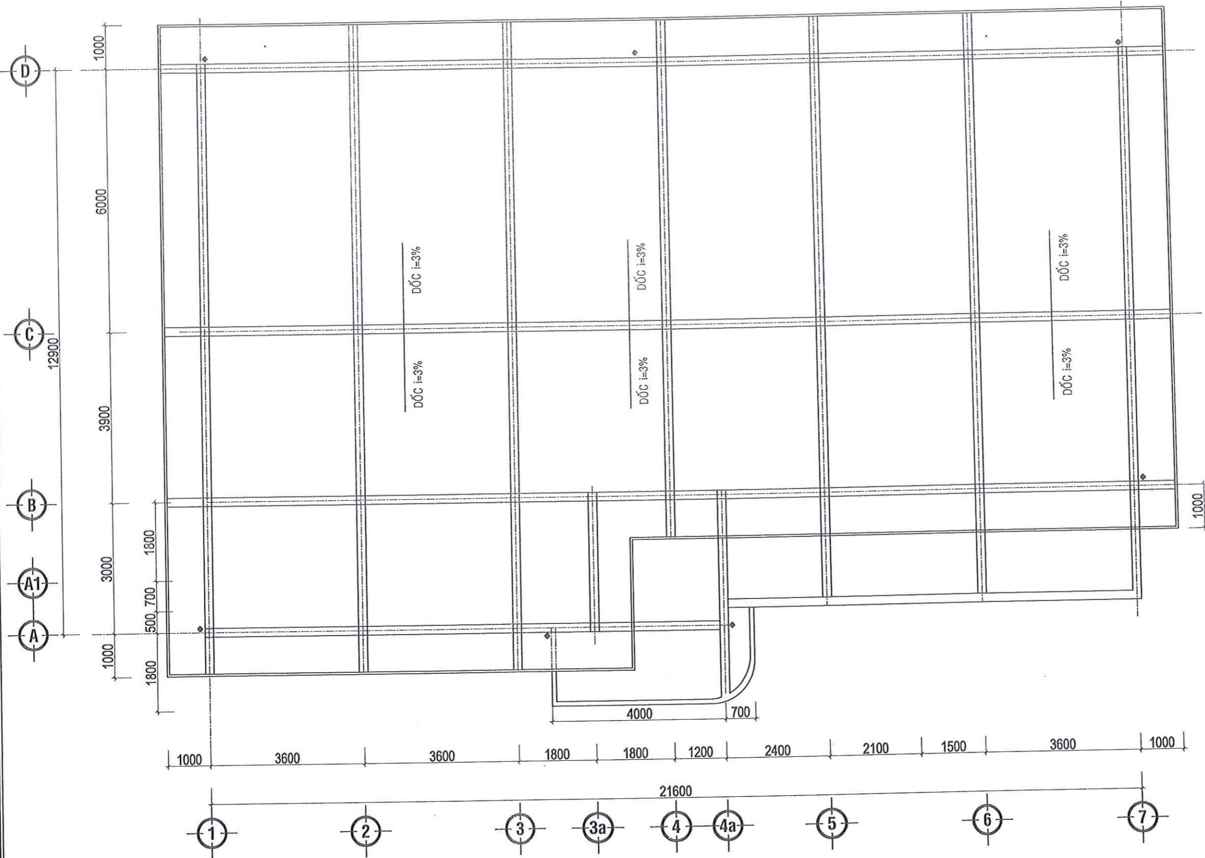
MẶT BẰNG MÁI (CẢI TẠO) TỈ LỆ: 1/100
