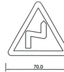
Biển số: W.202b (nhiều chỗ ngoặt nguy hiểm liên tiếp mà chỗ ngoặt đầu tiên hướng vòng bên phải) Road signs: W.202b (Many dangerous turns in a row the first turn turns to the right)
