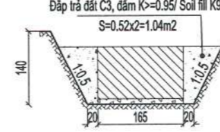
MẶT CẮT IV-IV / SECTION IV-IV SĐÀO= 3.85M 2 ; L=0.3M
