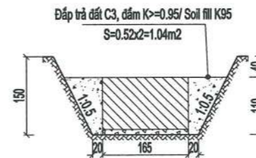
MẶT CẮT IV-IV / SECTION IV-IV ĐÀO = 4.20M 2 ; L=0.3M
