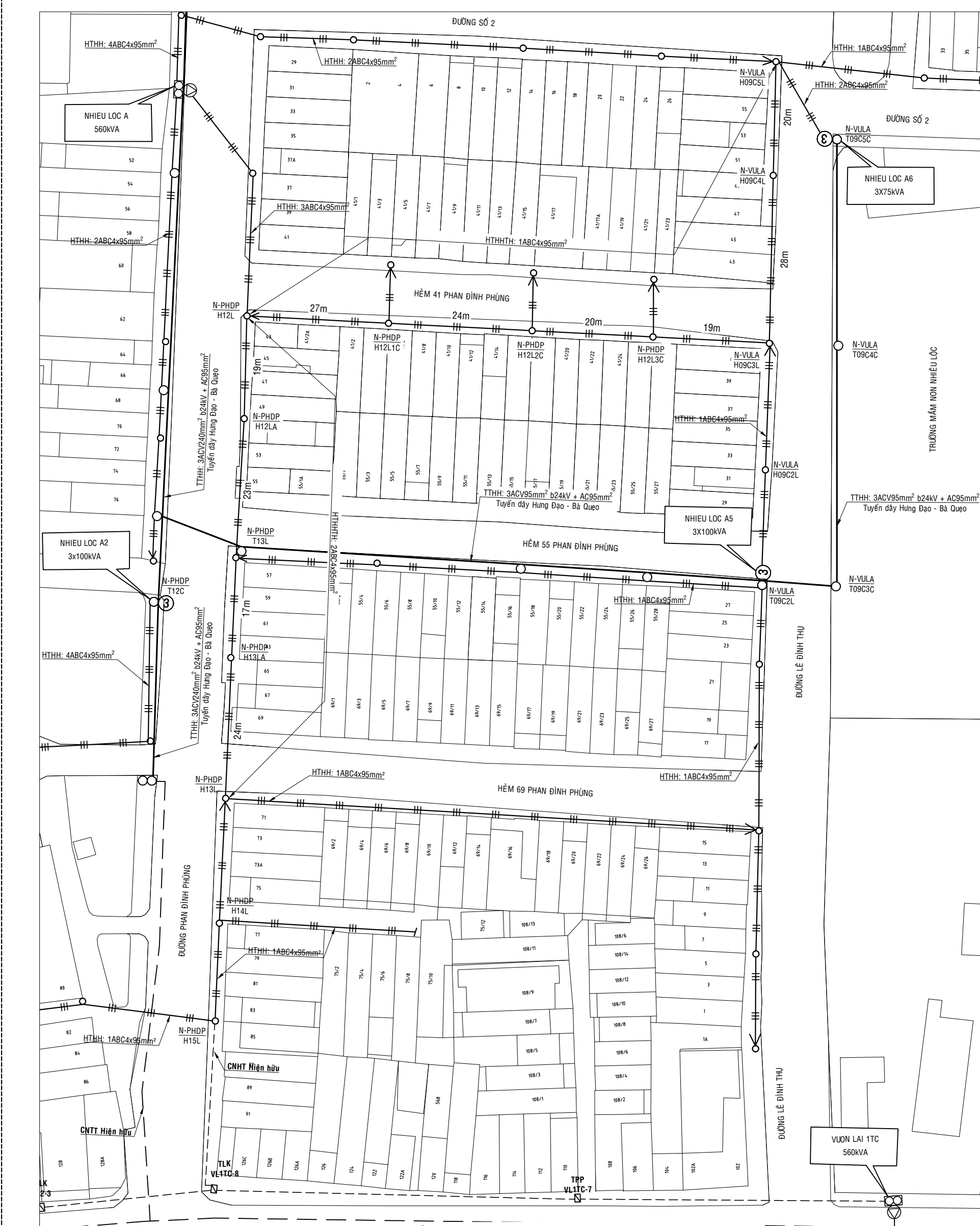
7. MẶT BẰNG TRẠM LƯỚI ĐIỆN TRUNG, HẠ THẾ HIỆN HỮU KHU VỰC DỰ KIẾN XDM TRẠM ĐÌNH THỦ 17
