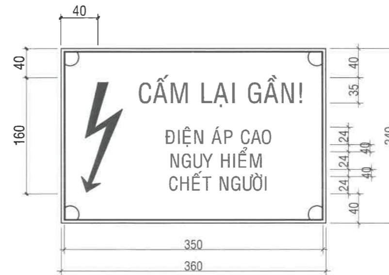
BIỂN TREO TẠI TỦ ĐIỆN HẠ ÁP
