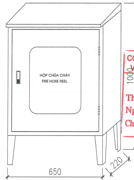
HỘP HỌNG NƯỚC CHỮA CHÁY NGOÀI NHÀ
