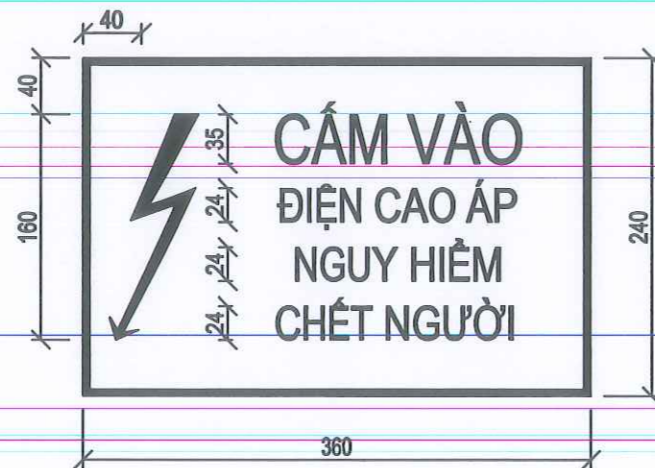
BIỂN BÁO AN TOÀN LẮP TRÊN CỬA HOẶC CỐNG TRẠM ĐIỆN CÓ TƯỜNG RÀO BAO QUANH (Theo hình 2 Thông tư 05/2021/TT-BCT) Viền và hình tia chớp màu đỏ tươi, nền màu trắng, chữ màu đen
