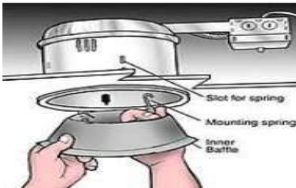
B3: Lắp đặt phần mặt
