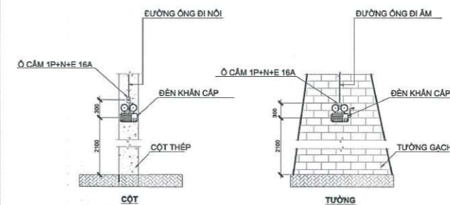
CHI TIẾT LẮP ĐẶT ĐÈN KHẨN CẤP
