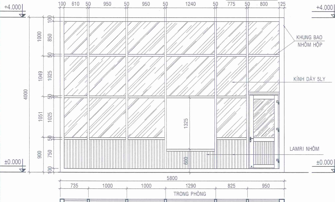
CHI TIẾT VÁCH V1 XÂY MỚI PHÒNG MÁY CÂN BẰNG (NHÔM KÍNH HỆ 1000, KÍNH CƯỜNG LỰC DÀY 5MM) SL: 01CK, TL:1/50
