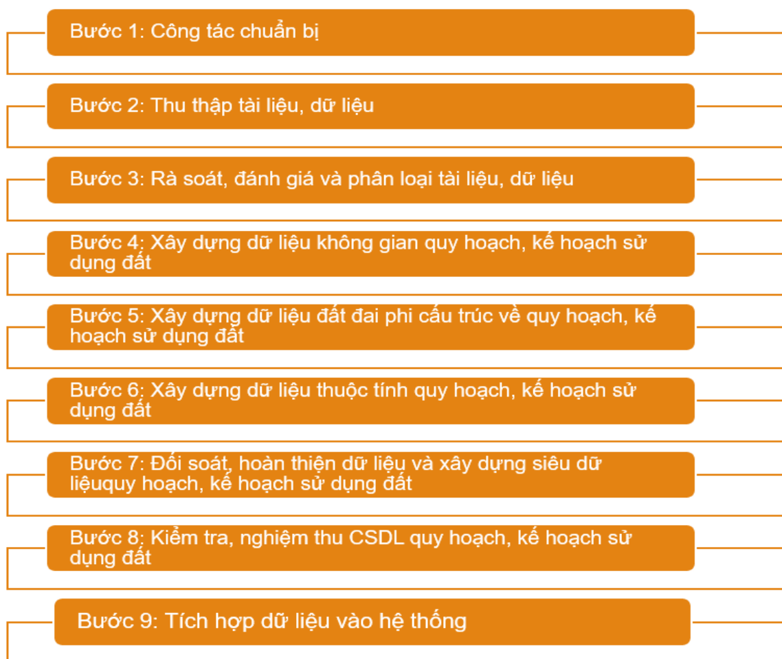
Hình 0-10: Quy trình xây dựng CSDL quy hoạch, kế hoạch sử dụng đất
