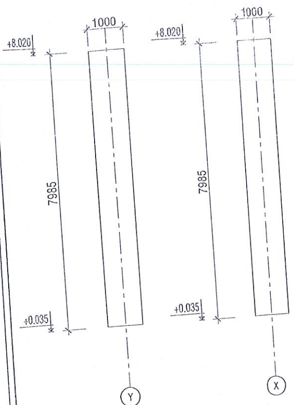
CHI TIẾT CỘT THÉP ỐNG D1000x12 TL:1/100
